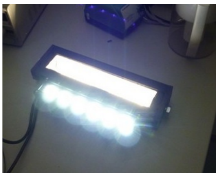
Сверху рефлекторный светильник рабочего света, снизу — линзовый светильник (водительский свет), разница очевидна.
